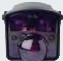
Radar- / Präsenzmelder Komfort Radar-Bewegungs- und Anwesenheitserkennung durch Infraroterkennung. Schnelle und gezielte automatische Toröffnung. Zuverlässige Vorfeldabsicherung. Bis max. 6 m Höhe. Bei hoher Luftfeuchtigkeit und in Außenbe- reichen nur Radar nutzbar. Gehäuse: Schutzart IP 65.
