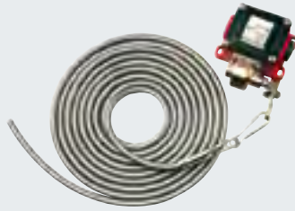
Zugschalter mit Kunststoff-Zugseil Montage waagrecht oder senkrecht möglich, Alu-Druckgussgehäuse IP 65, Seillänge 4 m.
