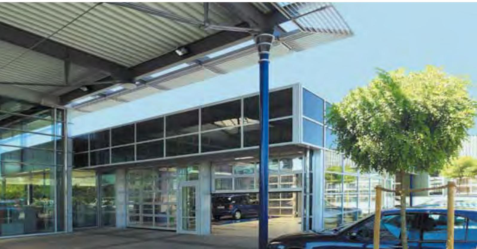
Großflächige Verglasung kombiniert mit ansprechenden Aluminium-Profilen zeichnet diese hochwertigen Sectionaltore aus. Sie verbinden zuverlässige Dauerfunktion mit den optischen Vorteilen des Aluminiums für eine moderne Architektur. Die stranggepressten, nach DIN 17611 eloxierten und im Naturton gebeizten (E6/C0) Alu-Rohrprofile sind witterungsbeständig. Auf Wunsch können die Profile auch in RAL-Farben pulverbeschichtet geliefert werden.
